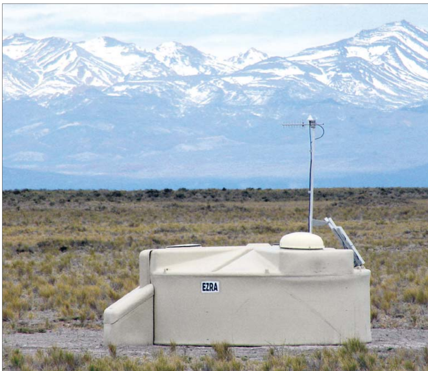
Die Ecken wurden abgerundet, weil sich Kühe daran scheuerten: Einer von demnächst 1600 Wassertanks in der argentinischen Pampa, mit denen die Quellen kosmischer Strahlung erforscht werden. Foto: Auger-Observatorium
