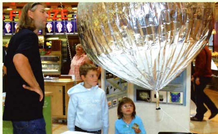
Dipl.-Phys. Julian Rautenberg, Mitarbeiter von Prof. Kampert, zeigt seinen Kindern Ambra und Philipp die „Falling Sphere“, eine „Fallende Kugel“ zur Messung der Dichte und des Windes in der oberen Atmosphäre.
