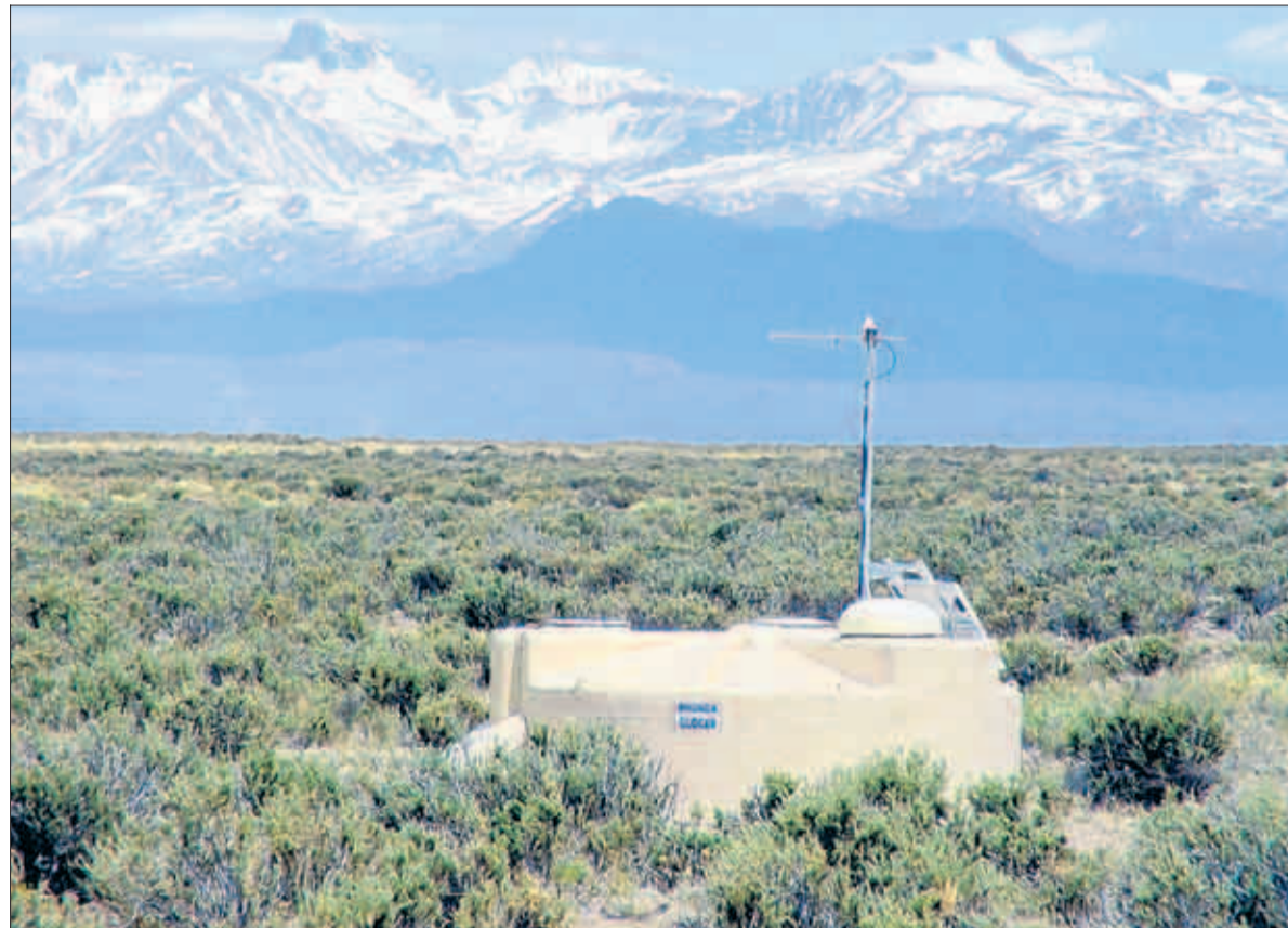
In der argentinischen Pampa wurden mannshohe Wassertanks mit Detektoren aufgestellt. Sie sollen kosmische Teilchen messen
