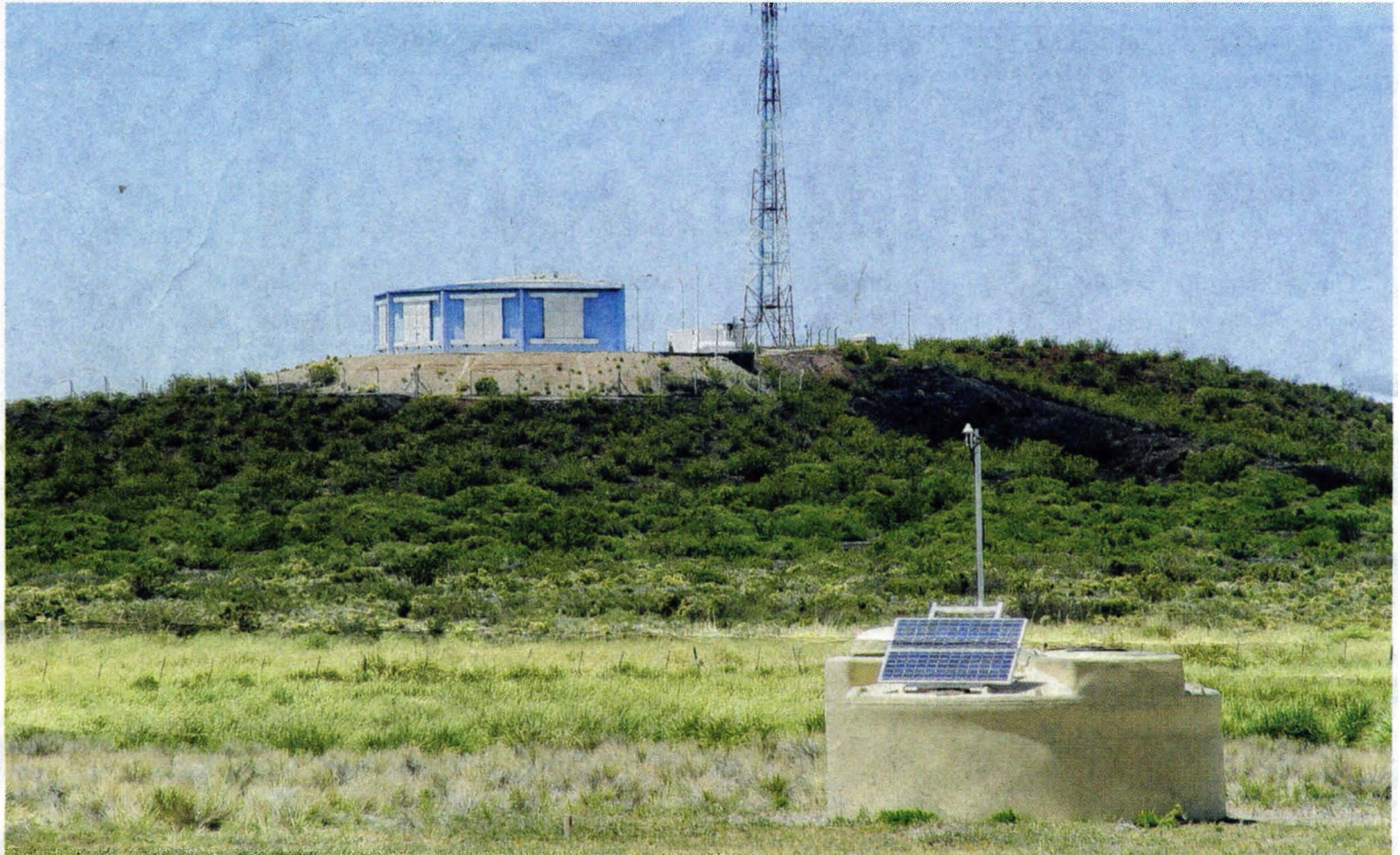
1600 Wassertanks mit je 12 000 Litern hochreinem Wasser sind auf dem Gelände in einer menschenleeren Provinz in Argentinien verteilt. Mit Spiegelteleskopen werden die Strahlungen beobachtet.
